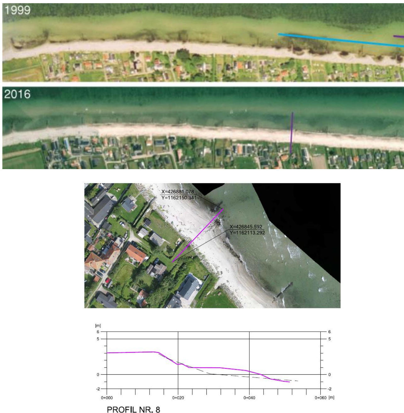
Figur 4-8 Strækning mellem Tørresø og Jørgensø dige. Strækning ikke besøgt d. 7. august 2017. Sandfodring i 2005 og 2009 markeret med blått hhv. lilla, se Tabel 3-1. Profil 8 markeret på 2016-plan med lilla linje. Lilla og stippet sort kurve på profil er opmåling fra hhv. 2017 og 1999.
