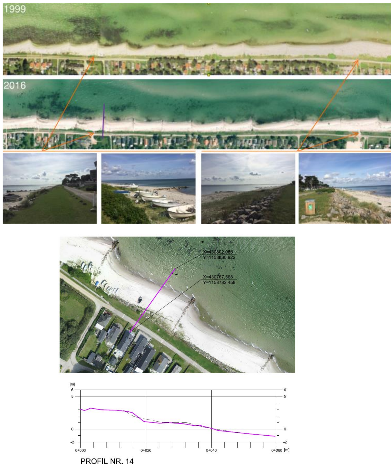
Figur 4-14 Hasmark østre dige. Strækning besøgt d. 7. august 2017. Profil 14 markeret på 2016-plan med lilla linje. Lilla og stiplet sort kurve på profil er opmåling fra hhv. 2017 og 1999.
