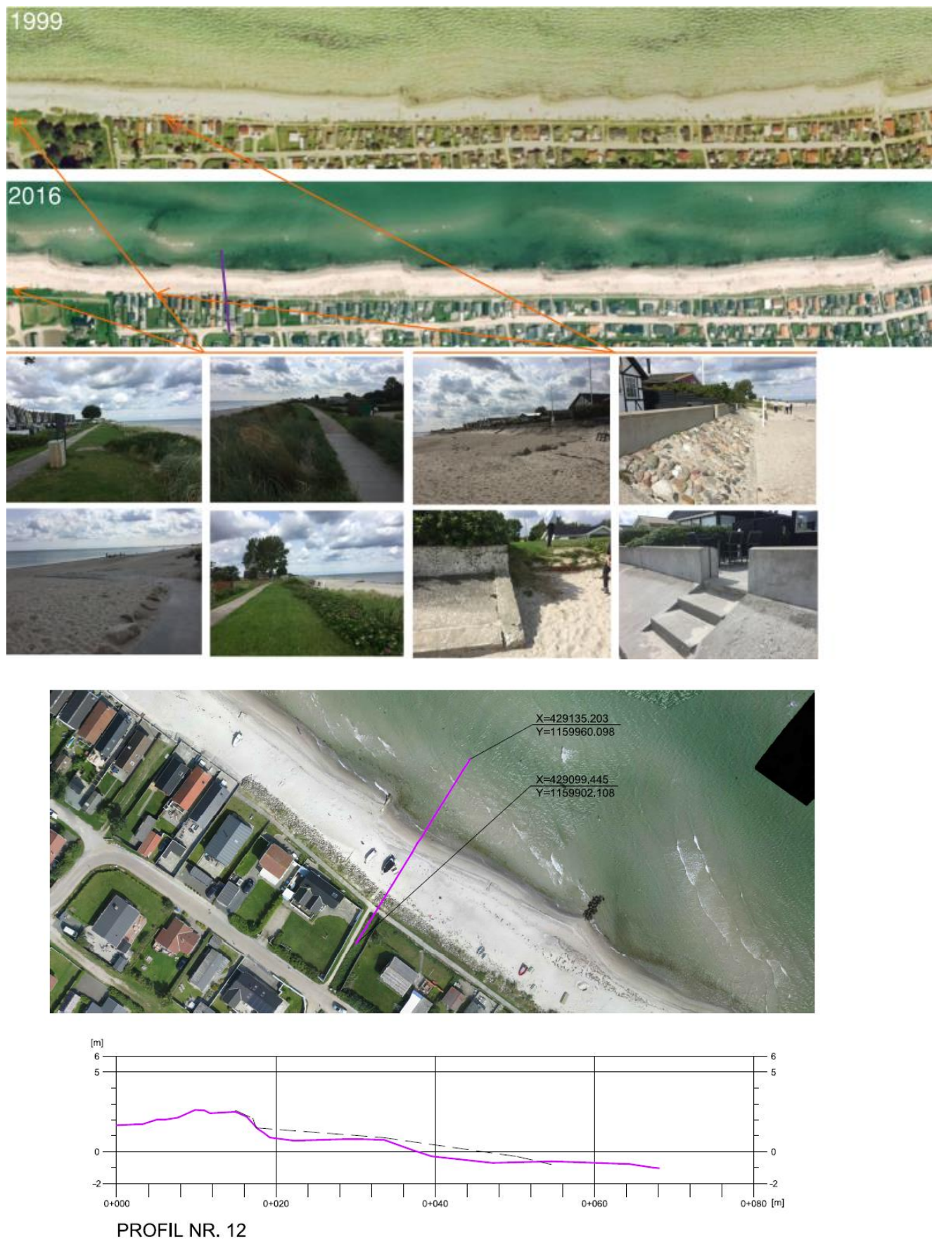
Figur 4-12 Hasmark mellemstræknings dige. Strækning besøgt d. 7. august 2017. Profil 12 markeret på 2016-plan med lilla linje. Lilla og stipleet sorte kurve på profil er opmåling fra hhv. 2017 og 1999.
