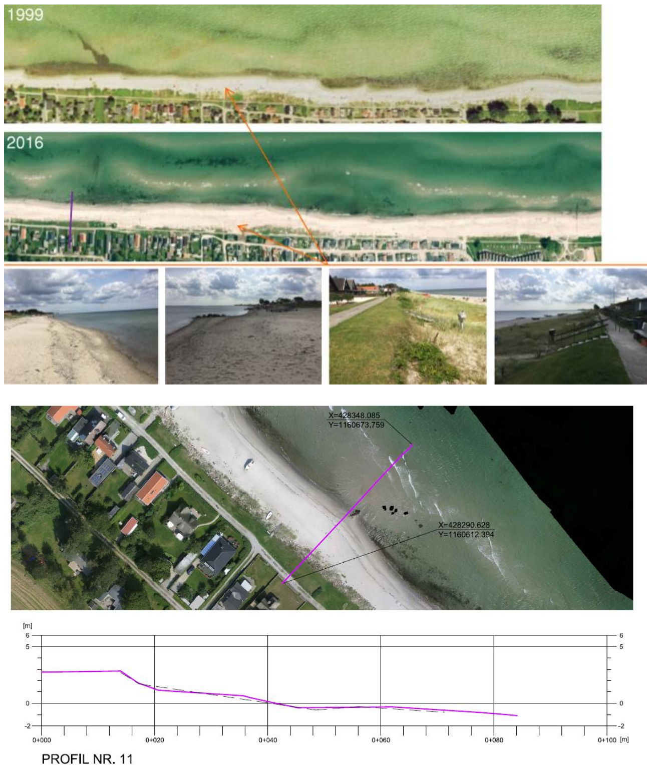
Figur 4-11 Hasmark vestre dige. Strækning besøgt d. 7. august 2017. Profil 11 markeret på 2016-plan med lilla linje. Lilla og stiplede sorte kurve på profil er opmåling fra hhv. 2017 og 1999.
