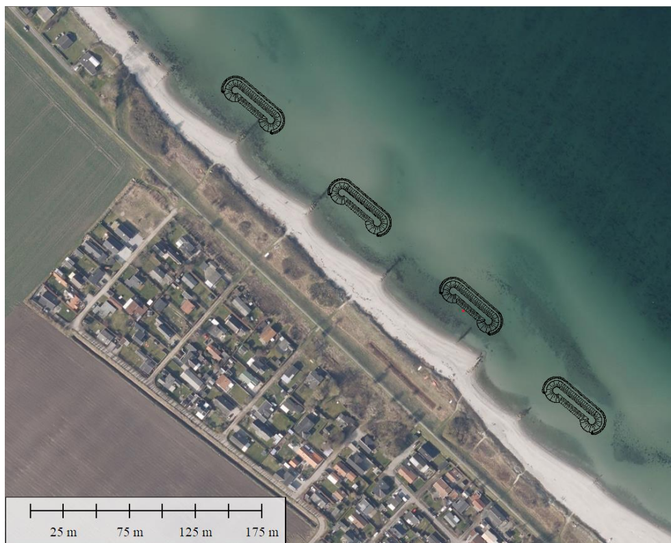
Figur 5-3 Plan over projekteringsforslaget af de fire bølgebrydere med indbyrdes afstand på ~60 m.
